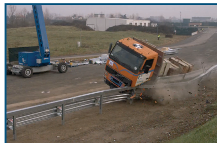
Ensaio TB 61 Caminhão 16.000kg, a 80 km/h e 20°
