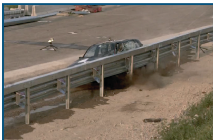
Ensaio TB 11 Carro 900kg, a 100 km/h e 20°
